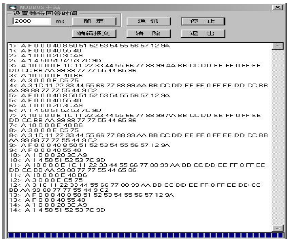
图 5-40 PC2 发送 0FH、01H、10H、03H 命令,对 0XXXX、4XXXX 读取
