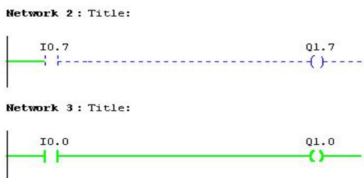
图 5-44 K0=Q1.0= PROFIBUS 输出有效
